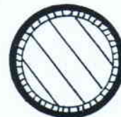
2. Laminatet byggs upp på gummiblåsan.
